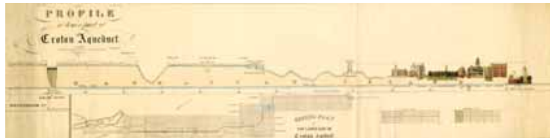
Профиль Кротонского акведука
